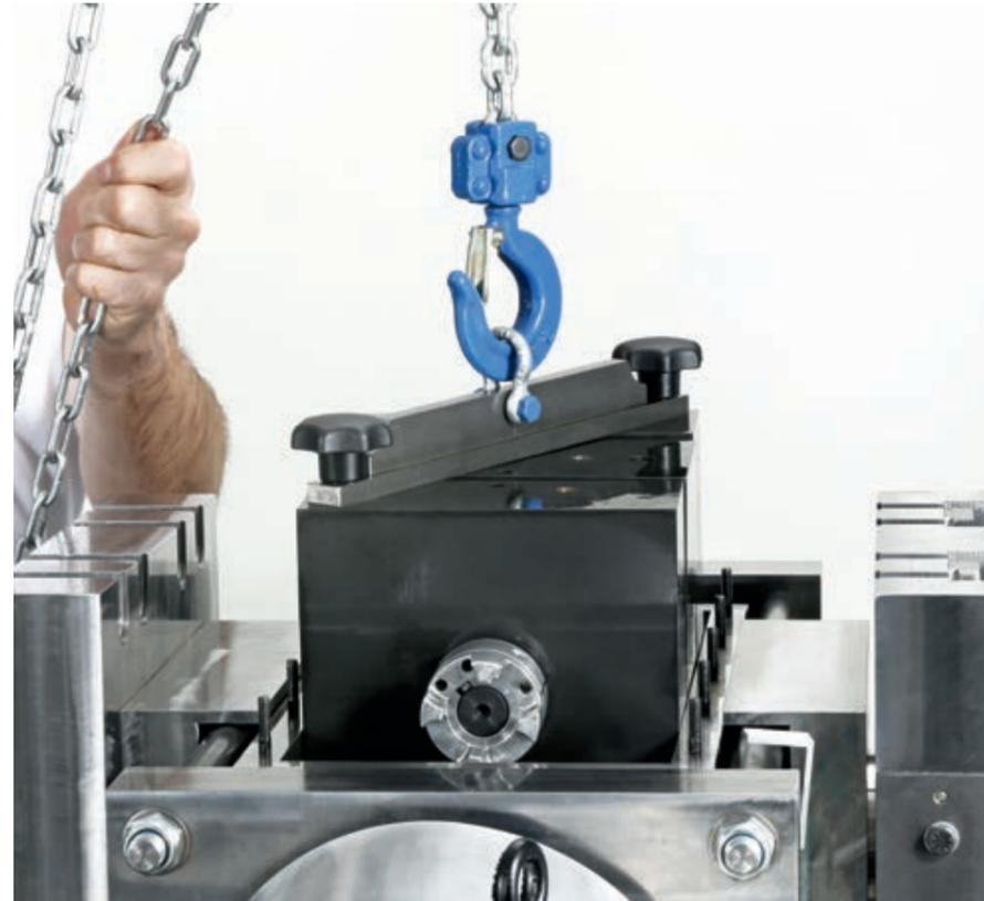
L'accent est actuellement mis sur les types de roulements rigides à billes 608 ou 6002, mais également sur les roulements 6205, qui sont installés par jeu de quatre. Une particularité du banc d'essai de LFD est constituée par l'application de la force de la charge radiale.
